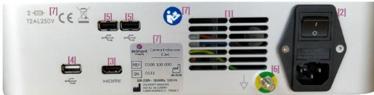
[1]: Le ventole sul retro dell'apparecchio non devono essere bloccate per evitare il surriscaldamento. La sorgente luminosa è dotata di un dispositivo di sicurezza automatico che arresta l'illuminazione se la temperatura interna diventa eccessiva. I ventilatori sul lato sinistro e sotto l'unità sono presenti anche per una migliore ventilazione.
