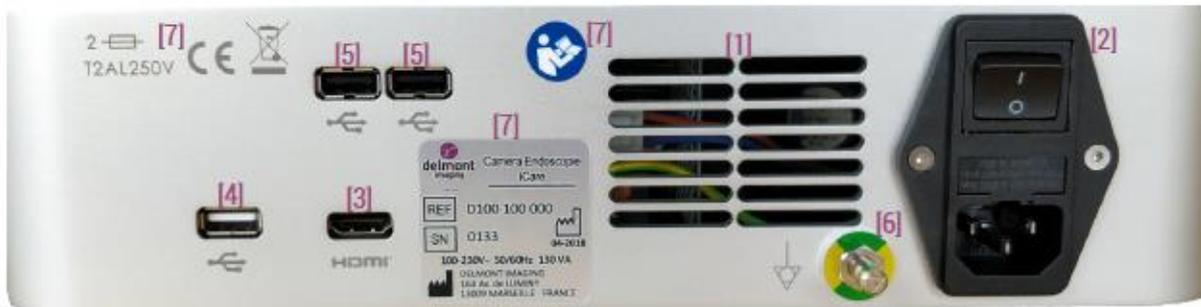
[1]: Les ventilateurs à l'arrière du dispositif ne doivent pas être bloqués pour éviter la surchauffe. La source lumineuse est équipée d'un dispositif de sécurité automatique qui arrête l'éclairage si la température interne devient excessive. Des ventilateurs sur le côté gauche et sous le dispositif sont également présents pour une meilleure ventilation.
