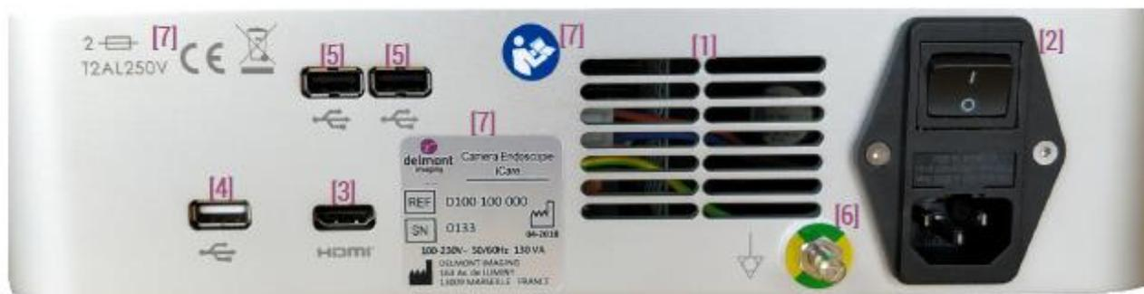
[1]: Los ventiladores de la parte trasera de la unidad no deben ser bloqueados para evitar el sobrecalentamiento. La fuente de luz está equipada con una función de seguridad automática que detiene la iluminación si la temperatura interna se vuelve excesiva. También hay ventiladores en el lado izquierdo y debajo de la unidad para una mejor ventilación.
